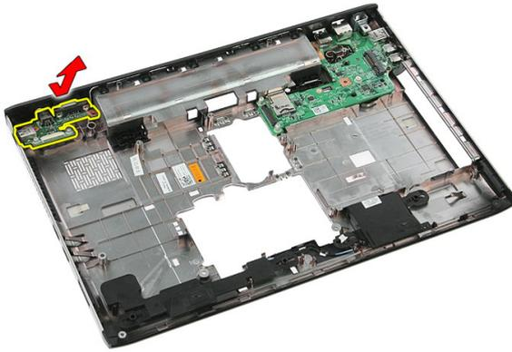
18. Retire o parafuso que fixa a placa de E/S da direita.
