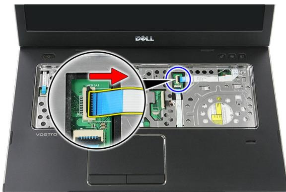
13. Abra o grampo de fixação do cabo de dados do leitor de impressões digitais.
