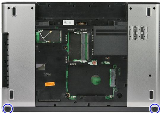
6. Retire os parafusos que fixam o apoio para as mãos ao computador.
