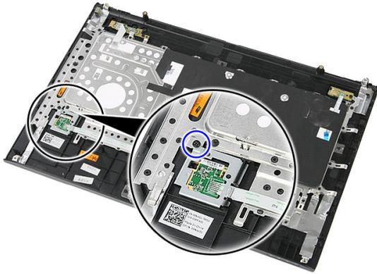
8. Levante o suporte do leitor de impressões digitais em ângulo e retire-o.
