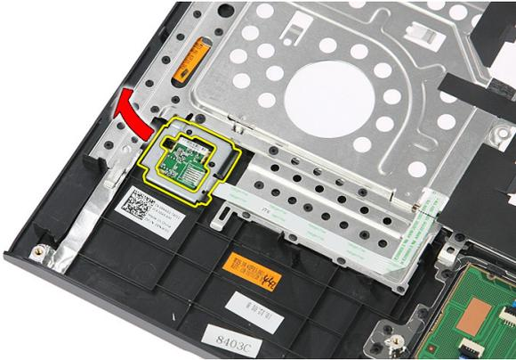
9. Destaque o cabo do leitor de impressões digitais da fita colada ao apoio para as mãos.
