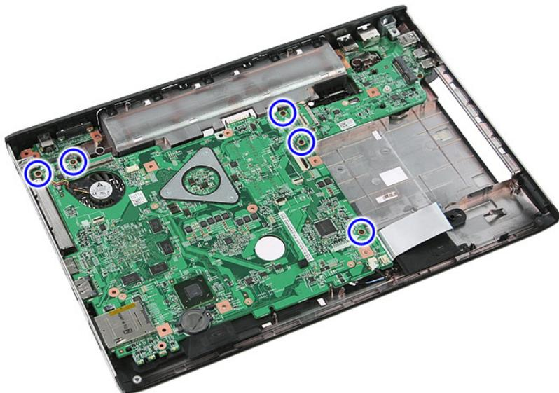
18. Levante a placa de sistema em ângulo e retire-a.
