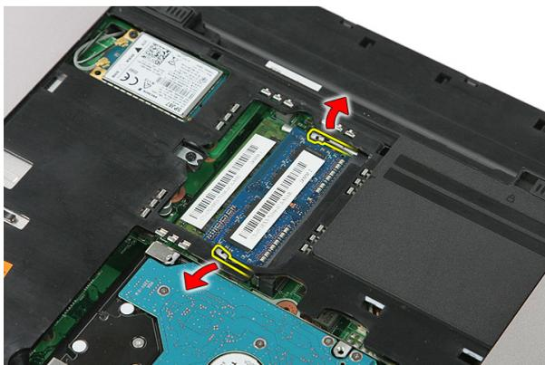
5. Retire o módulo de memória do respectivo conector na placa de sistema.
