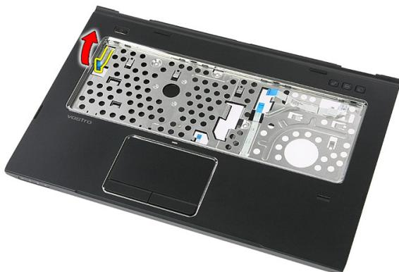
7. Retire o parafuso que fixa a placa do botão de alimentação.
