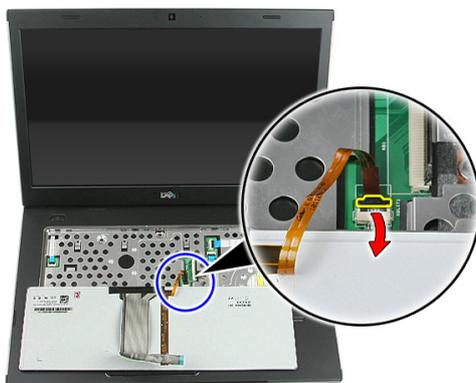
8. Se o seu computador foi fornecido com um teclado retroiluminado, desconecte o cabo de retroiluminação do teclado.
