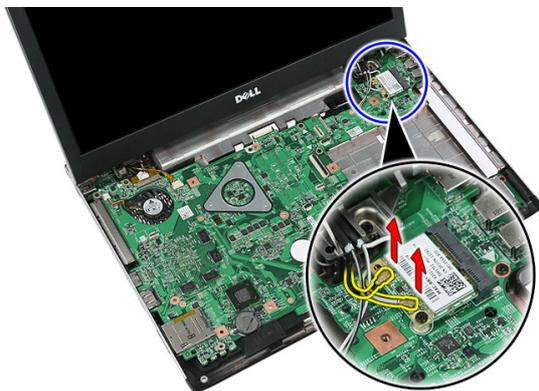
7. Retire o parafuso que fixa a placa WLAN.
