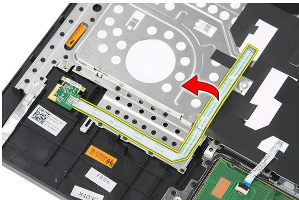
10. Levante a placa do leitor de impressões digitais e retire-a.
