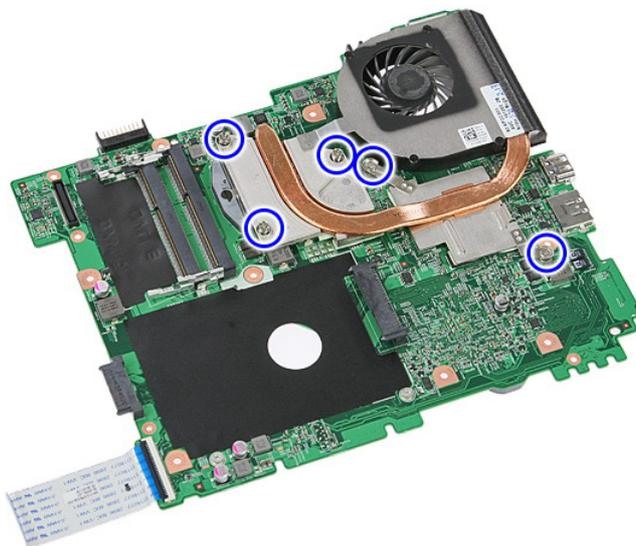
18. Levante o dissipador de calor e retire-o da placa de sistema.
