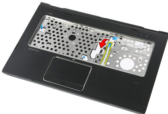
7. Retire o parafuso que fixa o suporte do leitor de impressões digitais.
