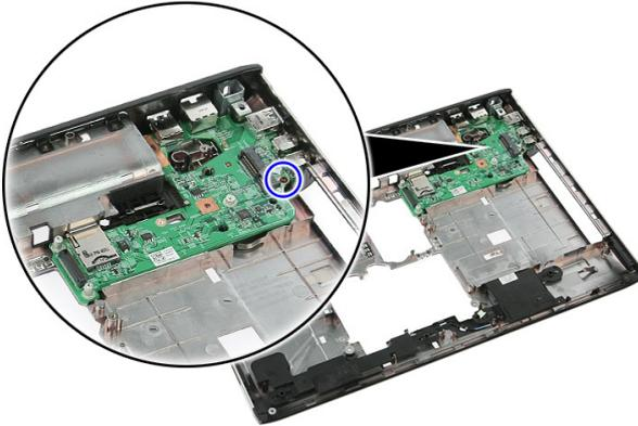
19. Levante a placa de E/S e retire-a.
