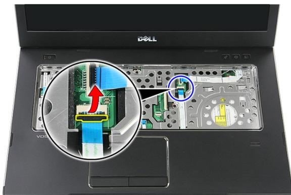
14. Desligue o cabo de dados do leitor de impressões digitais.
