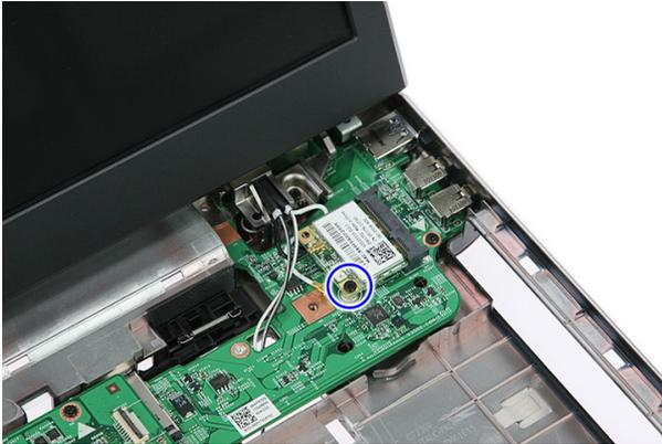
8. Retire a placa WLAN do computador.
