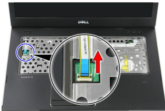
9. Abra o grampo de fixação do cabo de dados do painel tátil.
