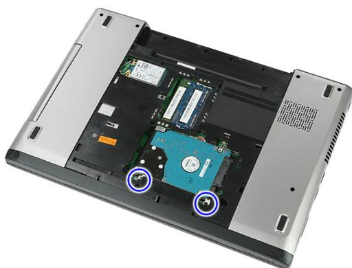
5. Levante a unidade de disco rígido em ângulo e retire-a do sistema.
