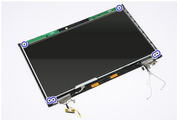
15. Levante e retire o painel do ecrã juntamente com os suportes e dobradiças.
