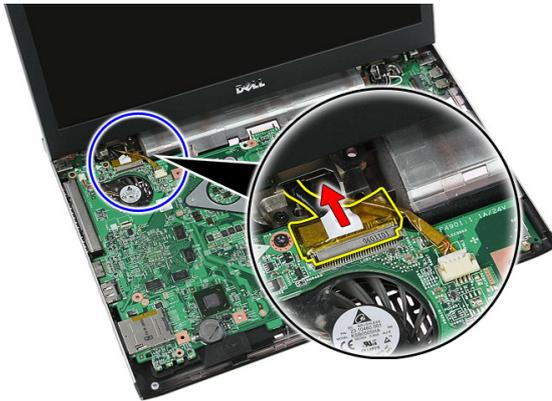
11. Se o computador foi fornecido com um painel tátil, desconecte o cabo do painel tátil.
