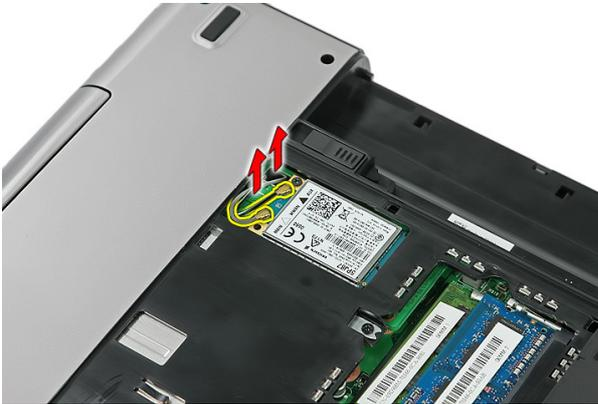
5. Retire o parafuso que fixa a placa WWAN.
