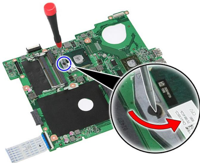
18. Levante o processador e retire-o.
